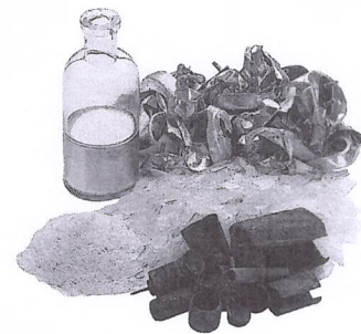
Figura 7: Componentes de lâmpadas fluorescentes separados (MRT, 1998).
